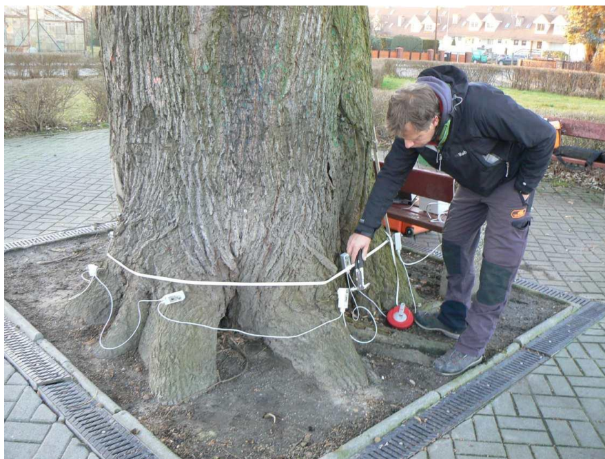
Ryc. 9 Widok na przebieg badania przy użyciu Arbotomu – badanie wykonane na wysokości 40 cm od poziomu gruntu. Widok od strony północno wschodniej
