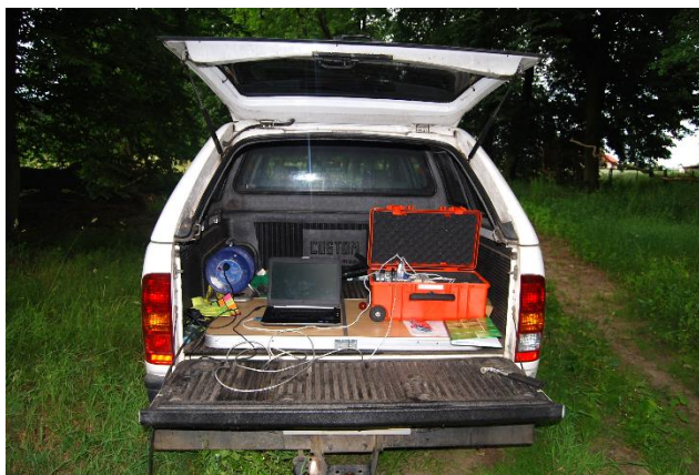
Ryc. 4 Stanowisko pomiarowe Arbotom™ z modułem rejestrującym
