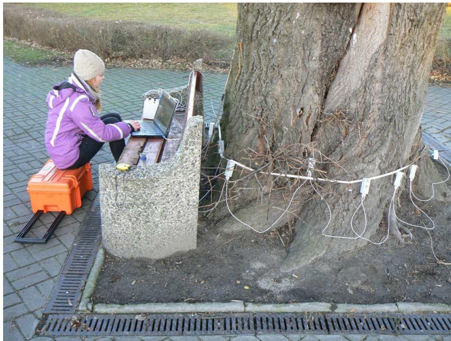
Ryc. 8 Widok na przebieg badania przy użyciu Arbotomu – badanie wykonane na wysokości 40 cm od poziomu gruntu. Widok od strony południowo zachodniej
